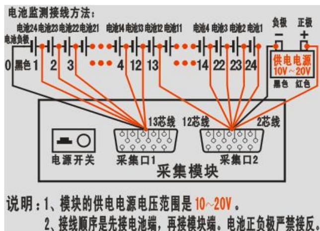
图 2.4.4 24 节 2V 电池与 1 个单体模块连接图
