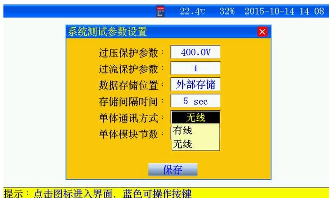
图 3.14 主机与单体模块通讯方式设置界面
