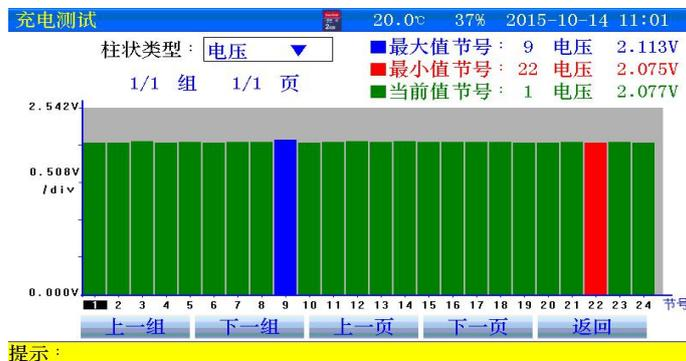
图 3.3.4-1 单体电压柱状图
