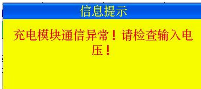
图 3.3.2-1 确定后提示，充电模块异常界面
