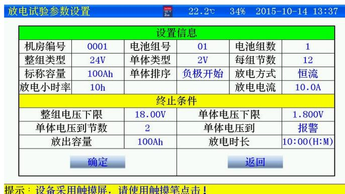
图 3.2.2 放电参数设置界面
